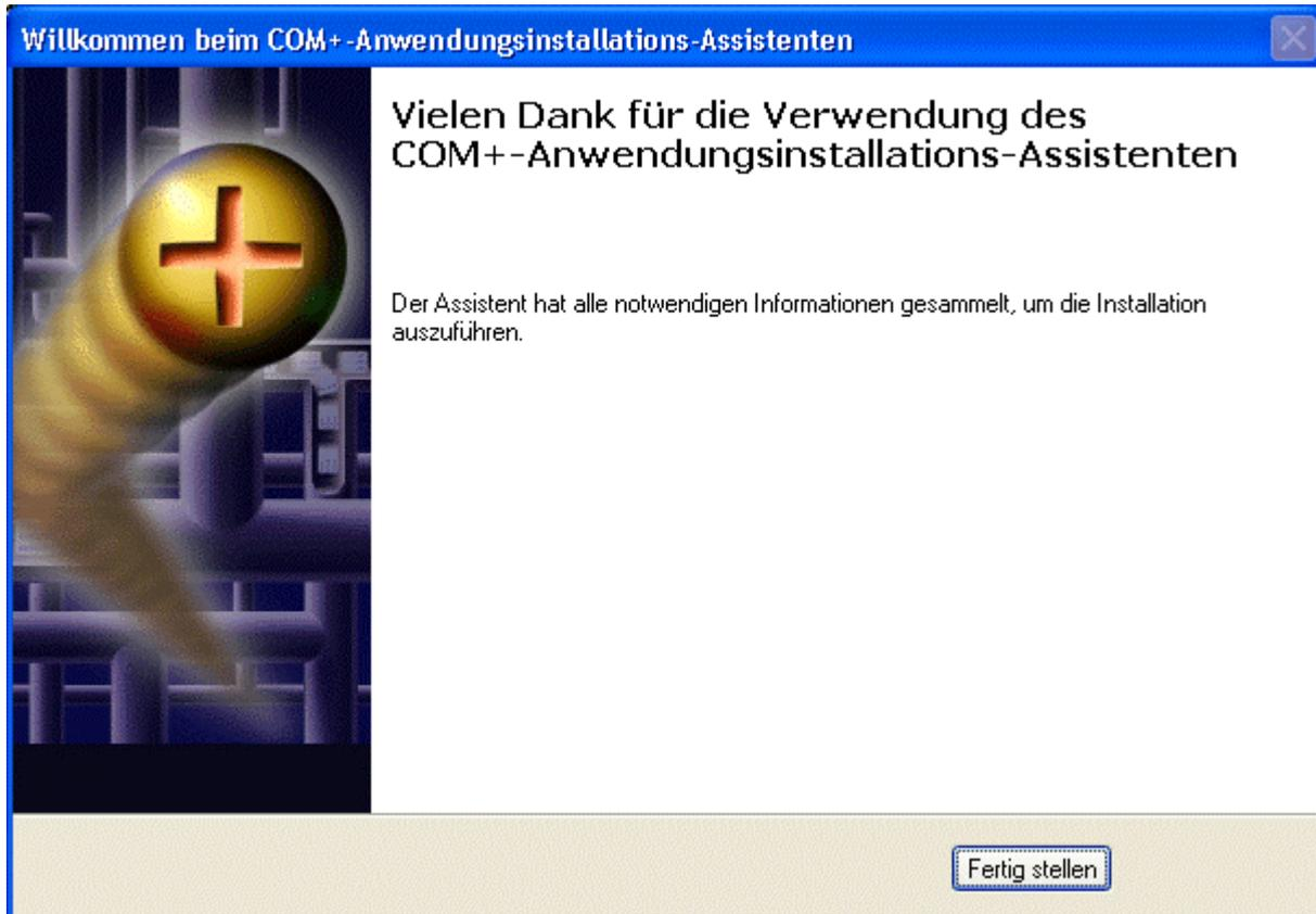
Zuletzt müssen noch die eigentlichen Komponenten (WEB Edition Objekte) registriert werden. Dazu muss zuerst die soeben erstellte Anwendung geöffnet und der Eintrag "Komponenten" markiert werden.
