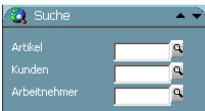
Mittels "Pfeil-nach-oben" und "Pfeil-nach-unten" kann dieses Suchfenster auf- bzw. zugeklappt werden.
